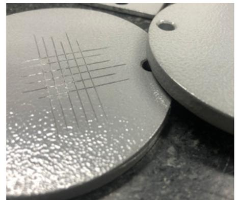
Após o processo de limpeza, com teste de grade grau zero
